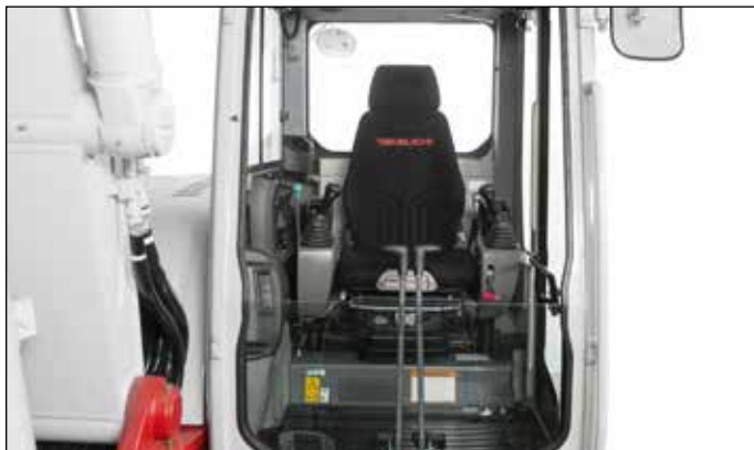
Asiento ergonómico con suspensión neumática con calefacción en el asiento, elementos de mando colocados de manera óptima para trabajar sin cansancio.
