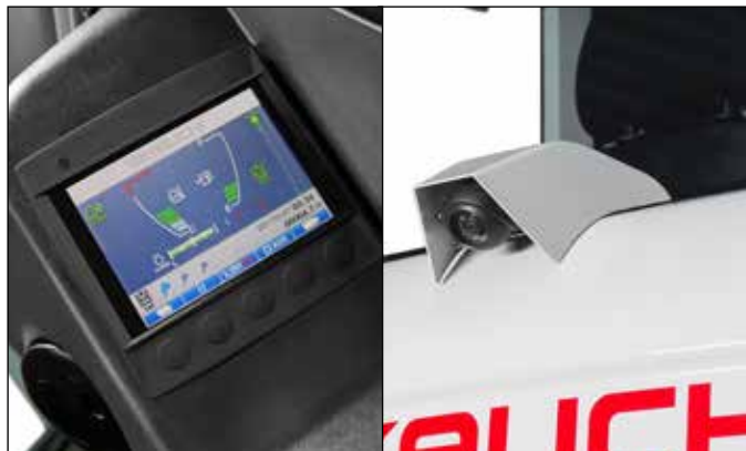
Nuevo display resistente a arañazos con visualización de la cámara de marcha atrás. Menu de taller con nuevas funciones.
