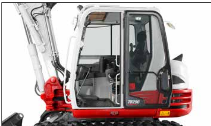
Amplia cabina insonorizada, pobre en vibraciones, compartimentos para guardar cosas, entrada ancha, fijación masiva de puerta, cristal frontal abatible, con aire.
