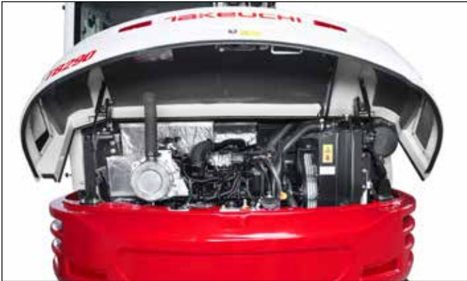
Motores con niveles reducidos de consumo, ruidos y emisiones de gases con agregados adicionales para minimizar el consumo y filtro de partículas auto-regenerante.
